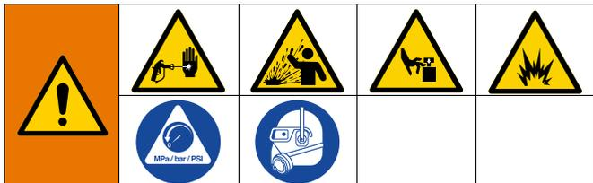
Это оборудование остается под давлением до тех пор, пока давление не будет сброшено вручную. Во избежание получения серьезной травмы, вызванной воздействием жидкости под давлением (например, в результате проникновения под кожу, разбрызгивания жидкости и контакта с движущимися деталями), выполняйте процедуру сброса давления после каждого завершения распыления и перед очисткой, проверкой либо обслуживанием оборудования.
