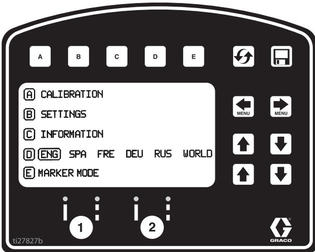
4. Нажмите кнопку **A** для выбора меню Калибровка. Установите значение РАССТОЯНИЯ ПЕРЕМЕЩЕНИЯ 7,6 м (25 футов) или больше. Расстояния с большей длиной обеспечивают лучшую точность в зависимости от условий работы.
